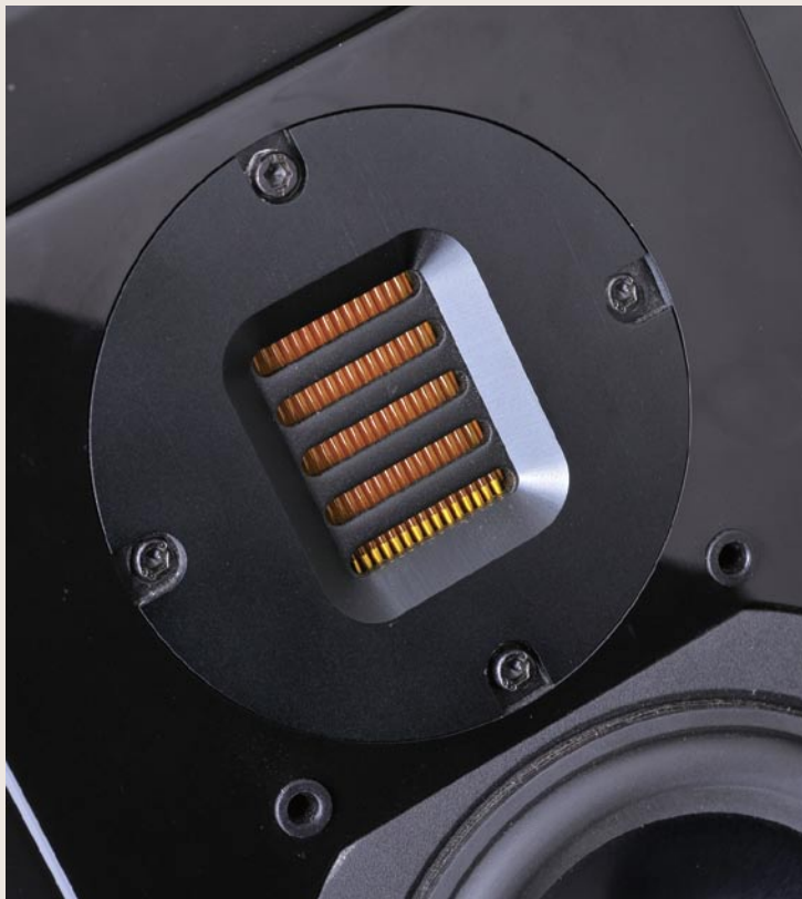
高音单元采用了海尔气动式设计，振膜采用风琴折叠式设计，振膜的展开面积比软球顶高音大了 6 倍以上
