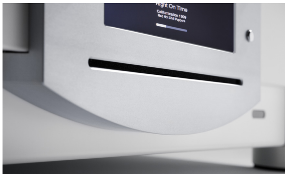
N31的讀取系統雖然是吸入式，但底部以三明治結構特別加強，二側更有V型擾流板來降低光碟旋轉時所帶來的壓力，可說設想周到。
