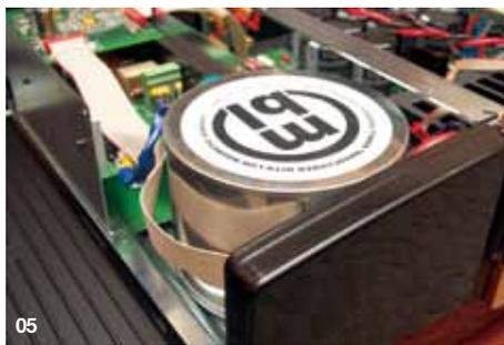
05. 專為C15量身訂製的大型變壓器用MU金屬外殼完全密封，利用MU金屬超強的隔磁特性排除磁漏干擾。
