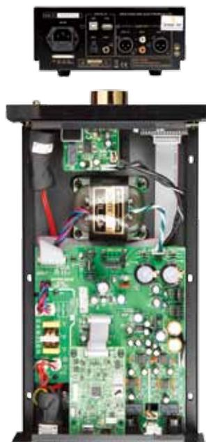
DAC25B的S/PDIF輸入部份以Cirrus logic CS8416接收，USB的部份則是這次DAC25B的最大進步，改用XMOS晶片處理，接著進入Burr-Brown SRC4192昇頻取樣晶片，這個部份在DAC25B的面板上可選96、192或關閉不作任何的昇頻動作，最後才進入Burr-Brown的PCM1792進行解碼。
